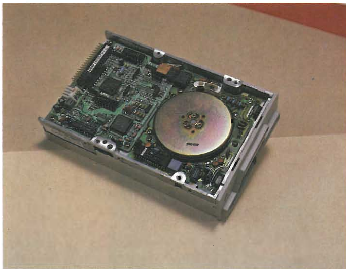
Particolare del floppy disk drive da 3,5 pollici. Si noti la compattezza del drive che è stato incorporato alla macchina.
