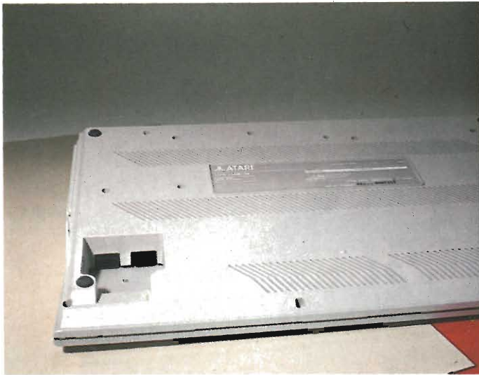
Come si può notare dalla fotografia, troviamo le due prese per il mouse/joystick nella parte inferiore del computer
