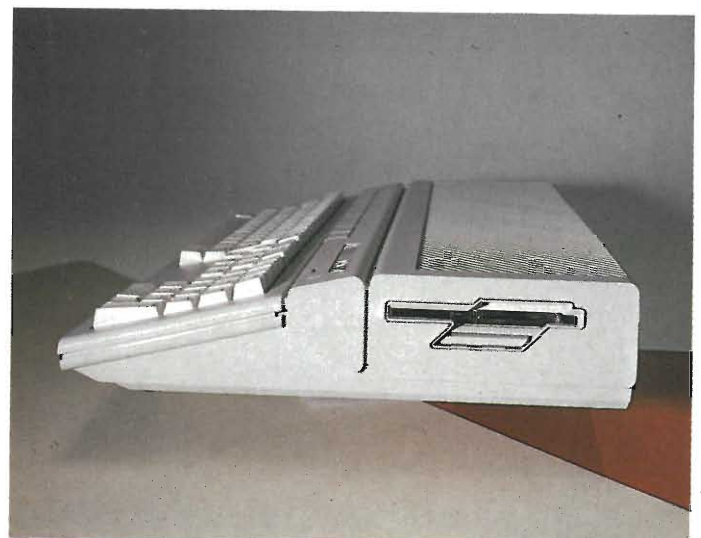
Il lato destro del computer è occupato dal drive da 3,5 pollici che consente una capacità di memorizzazione di 720K per dischetto
