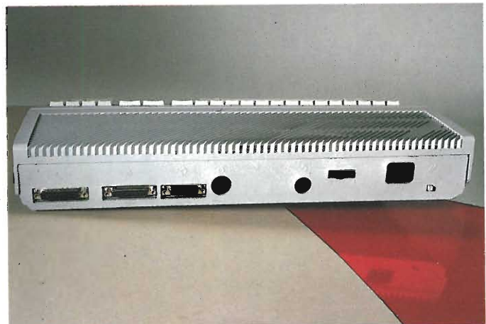
Retro del computer. Da sinistra: porta RS-232, porta Centronics, porta disco rigido, presa drive esterno, presa monitor, interruttore generale, presa alimentazione e tasto reset
