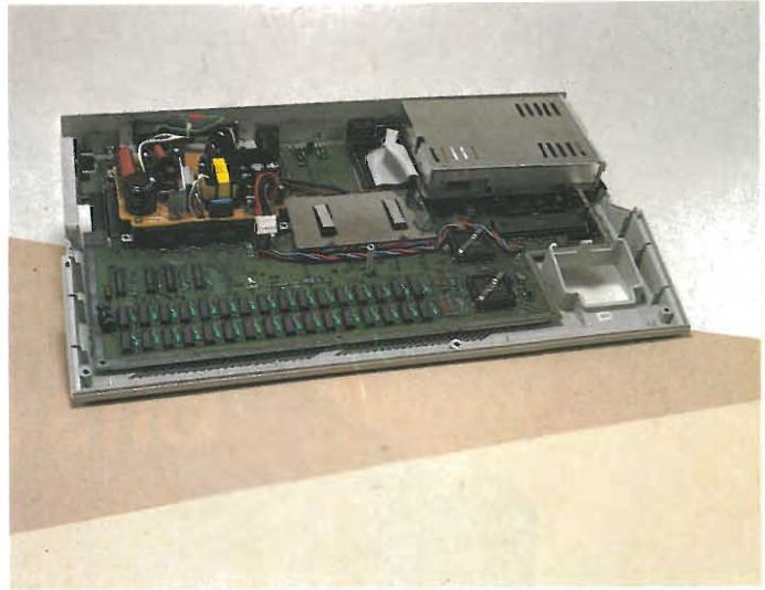
Particolare interno del 1040 STF. Si noti il piccolo floppy disk drive e il circuito per la trasformazione della corrente.
